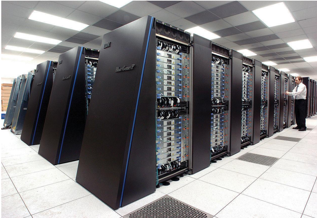
Slika 1: IBM Blue Gene/P superračunar "Intrepid" sa 164.000 procesorskih jezgara
