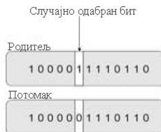
Слика 4. Мутација једног бита Извор: Chiroma et al.,
