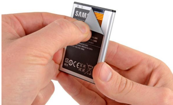
Слика 2. NFC антена на самој батерији [5]
